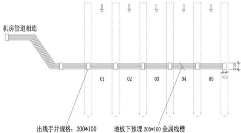
规划好出入境大厅内每条自助通道的安装位置，地面放样，确定线缆沟的中轴线和走向。接着开凿地面，预埋 200\*100 金属线槽，每条自助通道结构件下面预留出线孔，出线孔规格 200\*100。接下来每条自助通道至楼层设备间之间布放供电线缆和通信线缆。线缆布放完毕后，封闭金属线槽和地面恢复修整。
